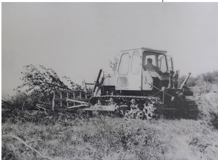
Fig. 12. Echipament de strâns arboret și cioate, tip ESAC-3,6 / Equipment for gathering trees and stumps, ESAC-3,6 type
