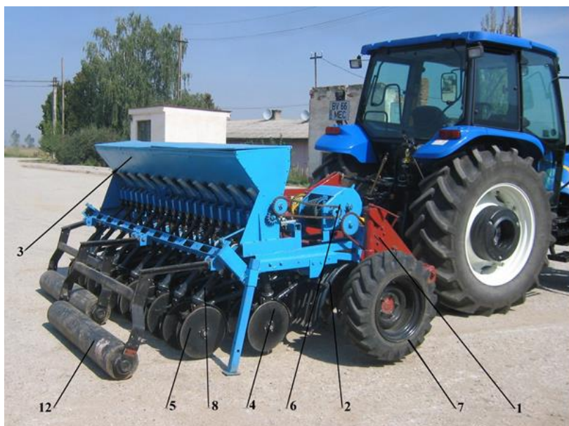
Fig. 22. Mașina combinată îmbunătățită, tip MCT 2,5 M / Rotary tiller-drill machine improved MCT 2,5M type
