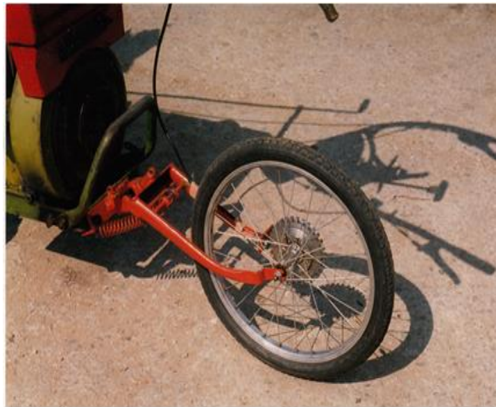
Fig. 42. Traductor pentru determinarea spațiilor și vitezelor / Transducer for determining the spaces and speeds
