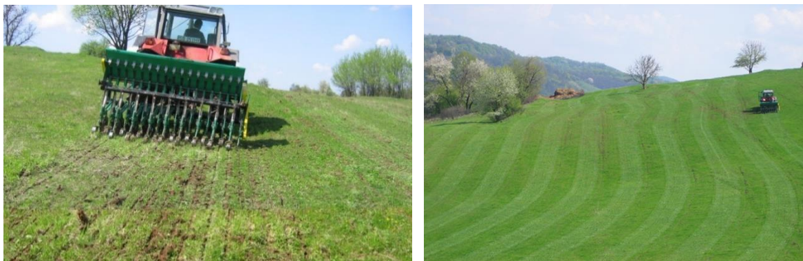
Fig. 19. Mașina de supraînsămânțat pajiști degradate, tip MSPD-2,5 / Grassland oversowing machine, MSPD-2,5 type
